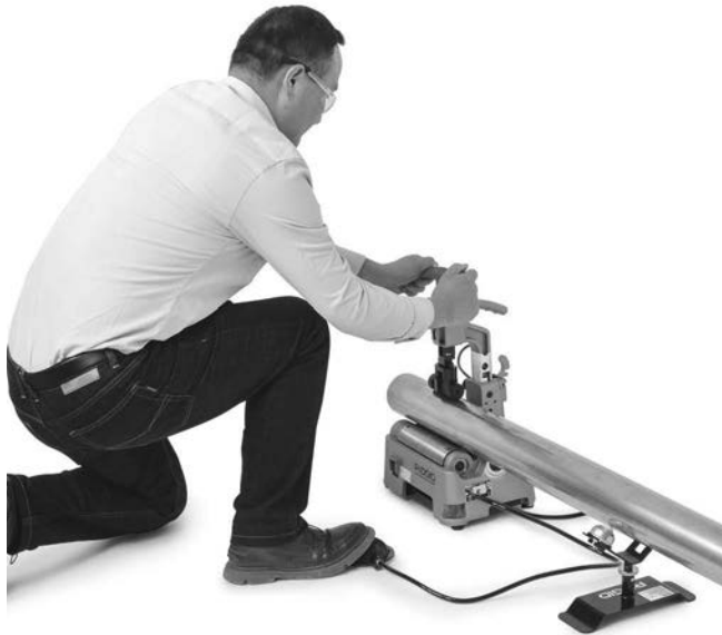
Figur 10 – Skæring af rør
