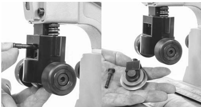
Slika 14 - Odstranjevanje nosilca kolesa
