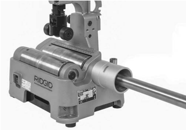
12. ábra – Cső sorjázása
