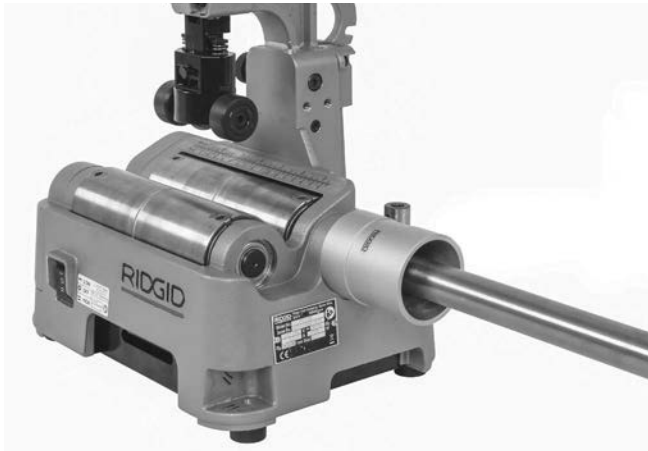
Εικόνα 12 – Ξύσιμο του σωλήνα
