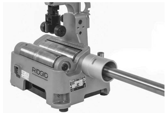
Figur 12 – Fræsning af rør
