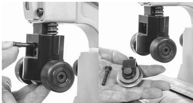
Figura 14 – Rimozione del supporto delle ruote
