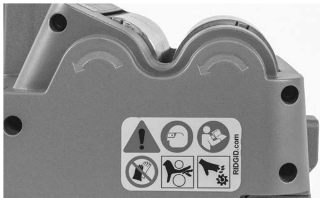
Slika 5 – Smjer okretanja valjaka
