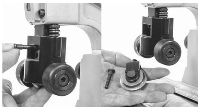
Figur 14 – Fjernelse af hjulholder
