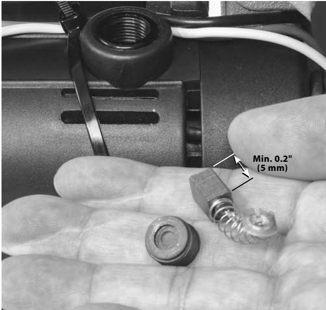
Figur 18 – Kontrol af børstelængde
