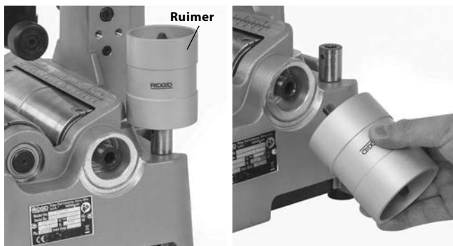
Figuur 11 – Ruimer installeren
