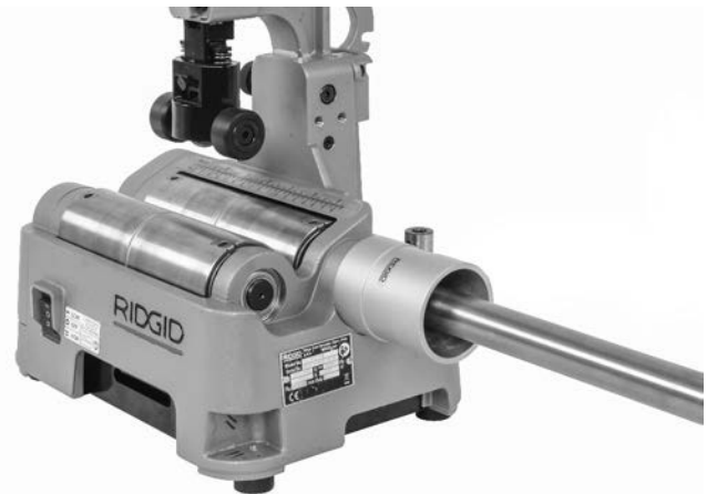
Figura 12 – Escariado del tubo
