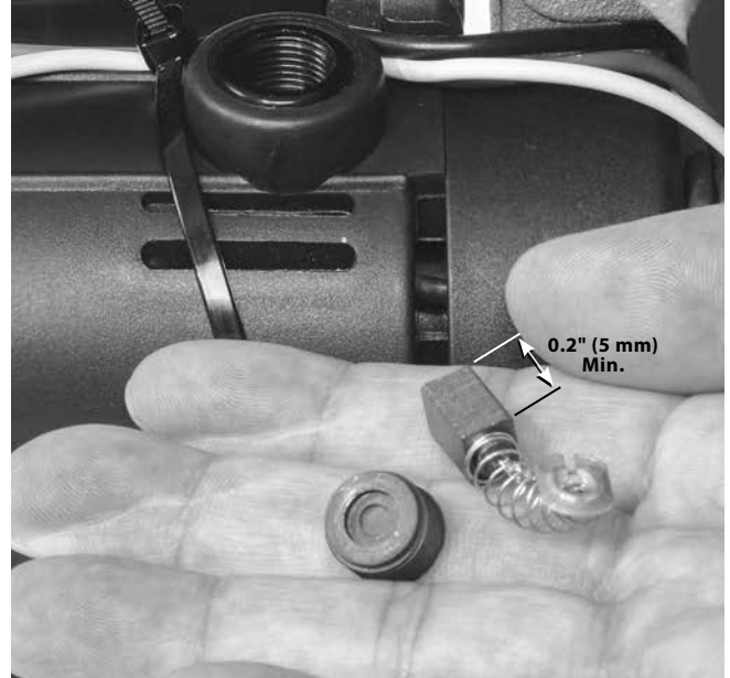
Şekil 18 – Fırça Uzunluğunun Kontrol Edilmesi
