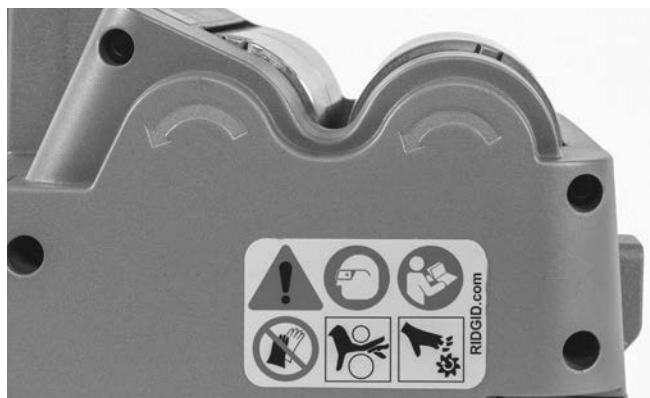
Figura 5 - Direzione di rotazione dei rulli
