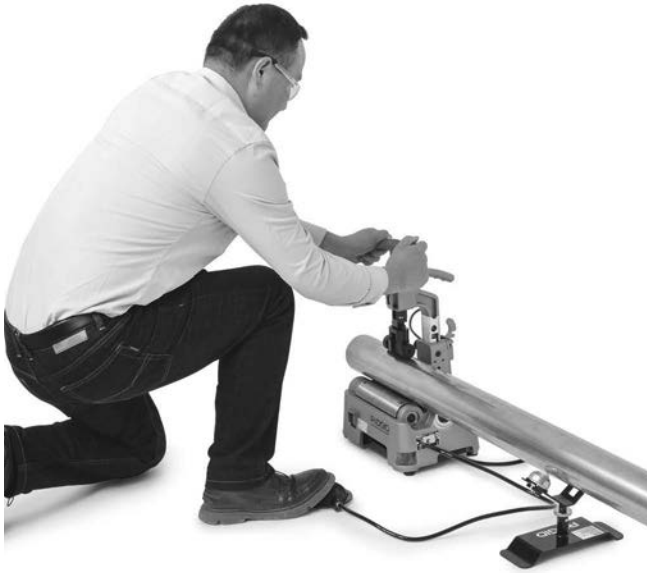
Figur 10 – Kutting av rør
