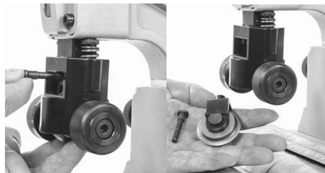
Figura 14 – Retirar o suporte de roda
