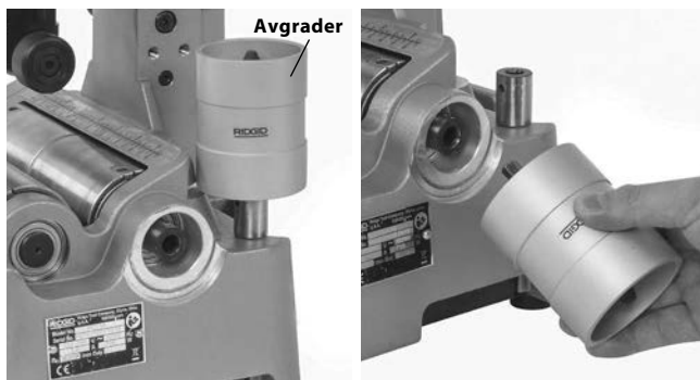
Figur 11 – Montering av avgrader
