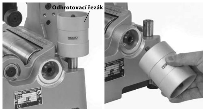
Obrázek 11 – Instalace odhrotovače
