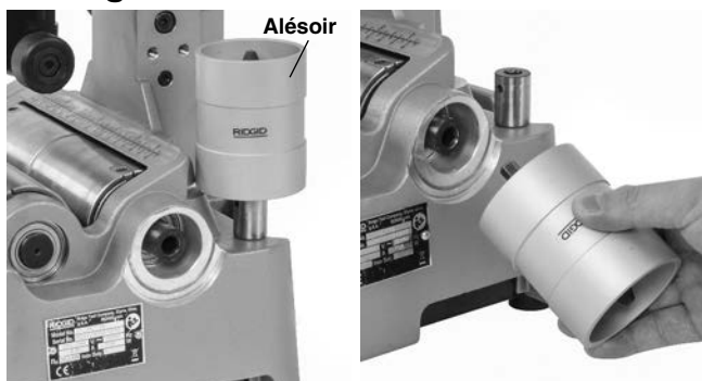
Figure 11 – Montage de l'alésoir
