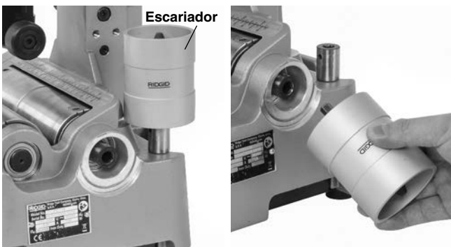
Figura 11 – Instalación del escariador
