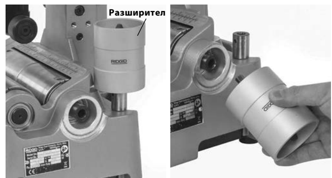
Фигура 11 – Инсталиране на разширител
