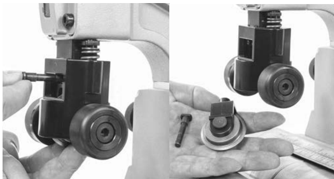
14. ábra – Görgőtartó eltávolítása
