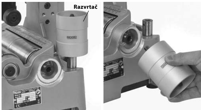
Slika 11 – Instalacija skidača srha
