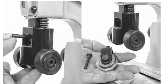
Figuur 14 – Houder van het snijwieltje verwijderen
