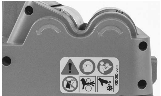
Şekil 5 - Rulman Dönüş Yönü
