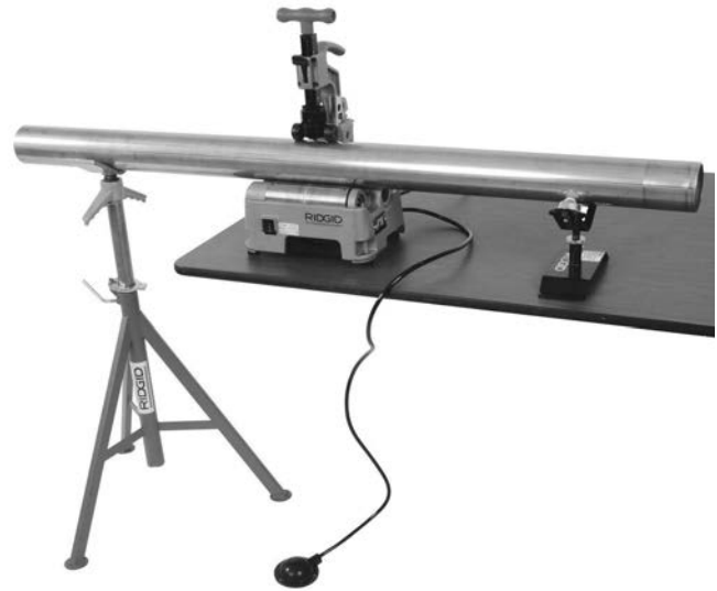
Figuur 3 – Opstelling van de steun
